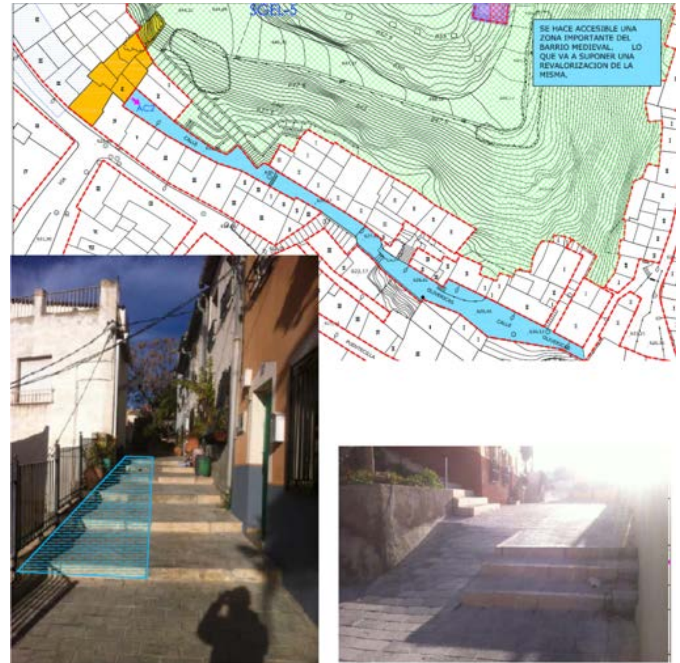
Figura 122. Zonas del casco histórico con posibles inclusiones de mejora de la accesibilidad mediante entonas con desniveles únicamente ejecutados mediante escalones.
